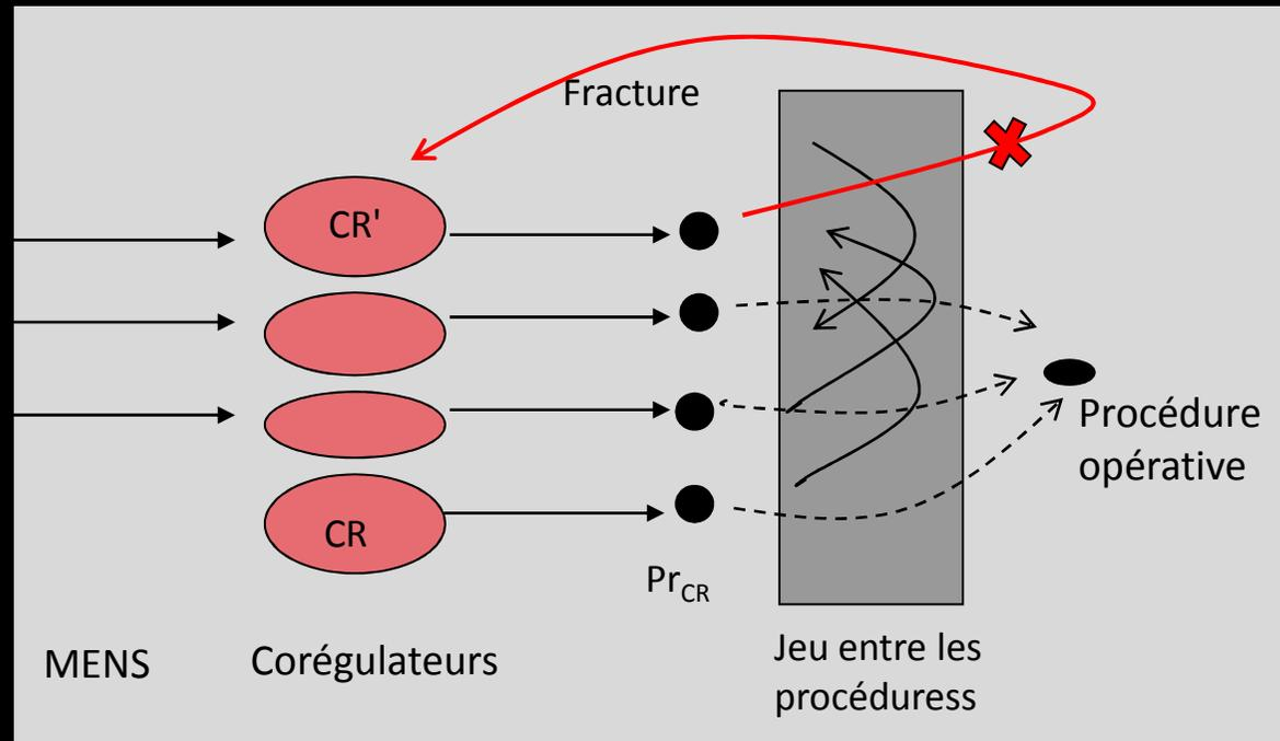
A l'instant  $t$ , les commandes des procédures choisies par les différents corégulateurs sont envoyées au système, où un processus d'harmonisation, le *jeu des procédures*, est déclenché, tenant compte des forces des divers CR et de leurs procédures. Il conduit à la procédure opérative qui sera effectivement exécutée par le système; celle-ci peut causer des fractures à un corégulateur CR dont la procédure n'est pas retenue.
